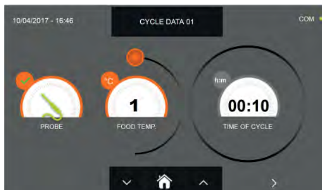
b - Osobně nastavený cyklus s teplotní sondou
