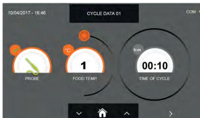
b- Cykl spersonalizowany z sondą temperatury
