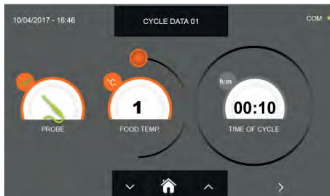
b- Manuální cyklus s teplotní sondou
