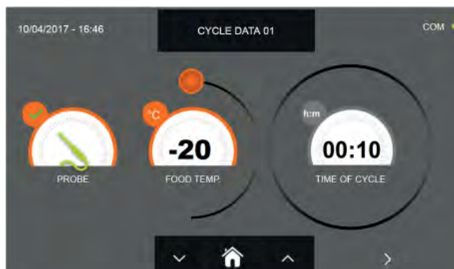
b- Cykl spersonalizowany z sondą temperatury
