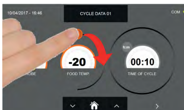
b- Nastavení hodnoty teploty
